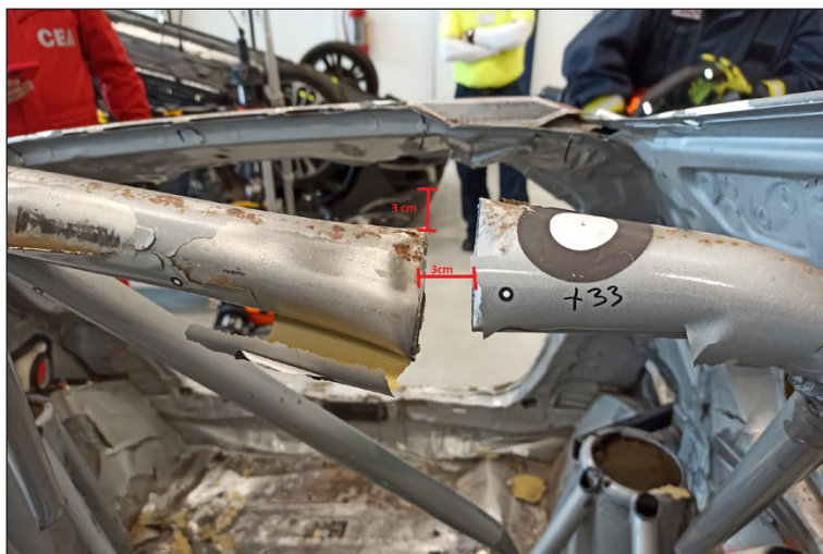
Slika 3. Pomak cijevi nakon rezanja deformiranog kaveza
